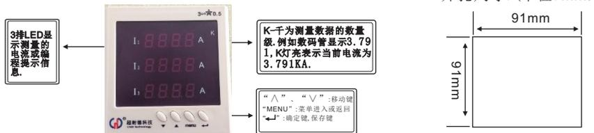
注:“^”、“v”, 切换移动键实现菜单项目的切换或者数字量的增加或减少。例如, 同时按住“^”+“MENU”数字将十位递增, 同时按住“^”+“<”数字将百位递增。同时按住“v”+“MENU”数字将十位递减。同时按住“v”+“<”数字将百位递减。“<”选择后确认, 并返回到上次菜单
